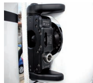
Ora è possibile azionare il riduttore manualmente
