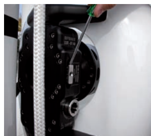
Sfilare il blocco riduttore posizionato su entrambi i lati destra e sinistra
