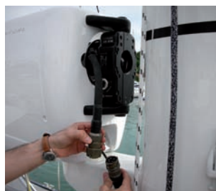
Staccare la spina di collegamento alla motorizzazione BFBMESS
