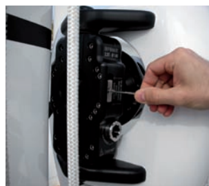
Svitare la vite del blocco riduttore manuale posizionato a destra e sinistra
